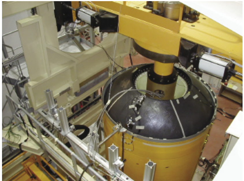
Vue d'un réservoir en phase de préparation de timbrage
