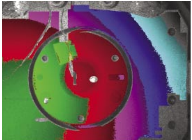
Mesure de déplacements sur détecteurs infrarouge - SAGEM.
