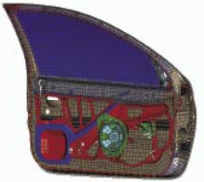
Modèle pour le calcul par éléments finis. L'objet des mesures est de corrélérer les calculs.
