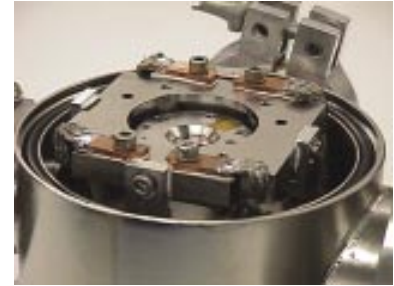
Le détecteur monté dans le cryostat est refroidi à 80 K.
