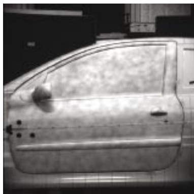
La portière d'essai montée sur son bâti. Le champ observé a une largeur de 1400 mm.
