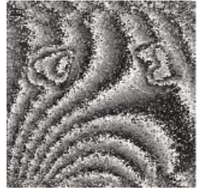
Défauts plans artificiels sur étalon en élastomère - SEP division SNECMA.
