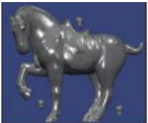
Le nuage de points triangulé est directement utilisable pour l'usinage ou le prototype rapide.
