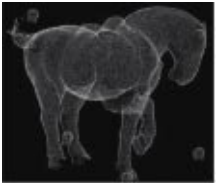
Vue de l'objet complet – Les nuages de points correspondant aux différentes vues sont assemblés grâce aux sphères placées autour de l'objet.
